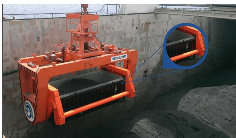
Рис. 4. Использование специализированных спредеров (RAM Spreaders) для перевалки каменного угля в морском порту «Port Elizabeth», ЮАР
