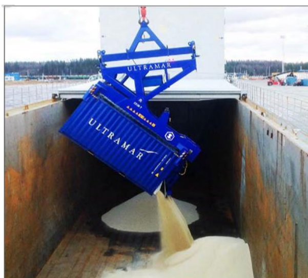
Рис. 3. Использование специализированных контейнеров в портовых операциях с минеральными удобрениями на терминале ООО «Смарт Балк Терминал» (оборудование брендировано ООО «Ультрамар»)
