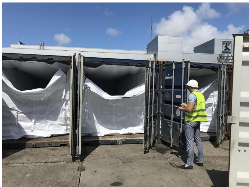
Рис. 5. Универсальные морские контейнеры с установленным мягким вкладышем, подготовленные под перевозку навалочных или насыпных грузов, ожидают загрузки и установки щита в дверях
